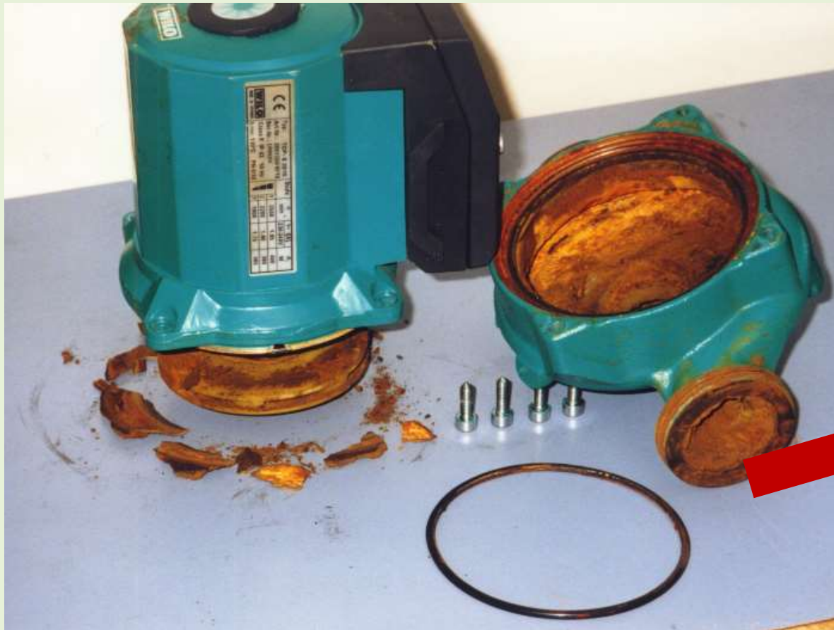
Šildymo sistemos cirkuliacinio siurblio korozija
